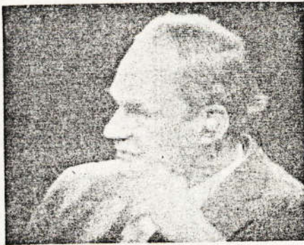
22. — Image TV avec un signal d'interférence de -50 dB relative à la figure précédente.
