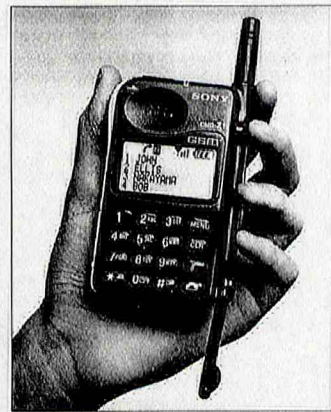
Sony a développé un terminal GSM plus court (12 cm) que les modèles classiques, qui intègrent un microphone dans le bas du boîtier. L'astuce? Le microphone est installé à l'extrémité d'un bras qui active le téléphone lorsqu'on le déploie.
